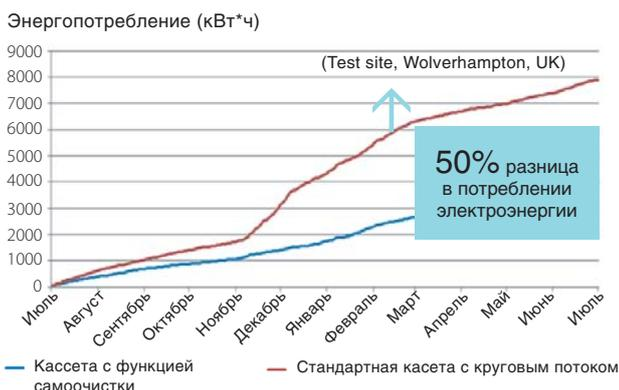
Сравнение суммарного за 12 месяцев энергопотребления стандартной кассетой и кассетой с функцией самоочистки
