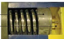
Потеря мощности не позволяет чиллерам достигать нормального режима остановки. Недостаточная смазка в данном случае может повредить подшипники и уменьшить продолжительность службы компрессора. Компрессоры оснащаются ёмкостью со смазкой и поршнем с сжимающей пружиной, которые позволяют подводить находящуюся под давлением смазку к подшипникам в период остановки. Также из-за низкой инерции режим остановки у компрессоров весьма непродолжительный.
